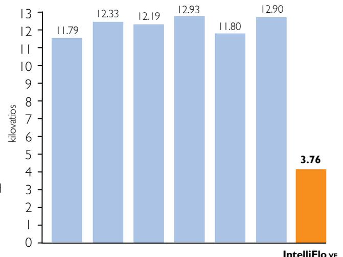
Los datos muestran los resultados de pruebas comparativas de consumo de energía entre IntelliFlo vF y seis bombas comunes para piscinas. En todos los casos, IntelliFlo vF consumió entre 68% y 71% menos de energía. En condiciones reales de uso, es posible que el ahorro sea significativamente mayor.
